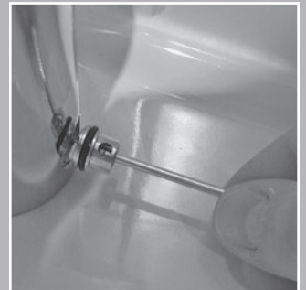
Inbusschraube vom Griffadapter mit Schlüssel SW 2,5 herausnehmen und abnehmen.
