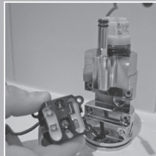
Elektronikmodul tauschen (mit LED auf Unterseite).
