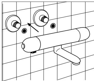
Schmutzfilter und Dichtungen einsetzen und Armatur montieren.
