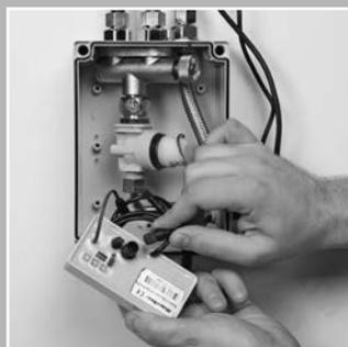
Elektronikmodul herausnehmen und alle Kabel lösen.
