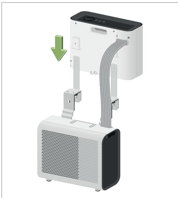
Abb. 9: Einhängen des Innengerätes
