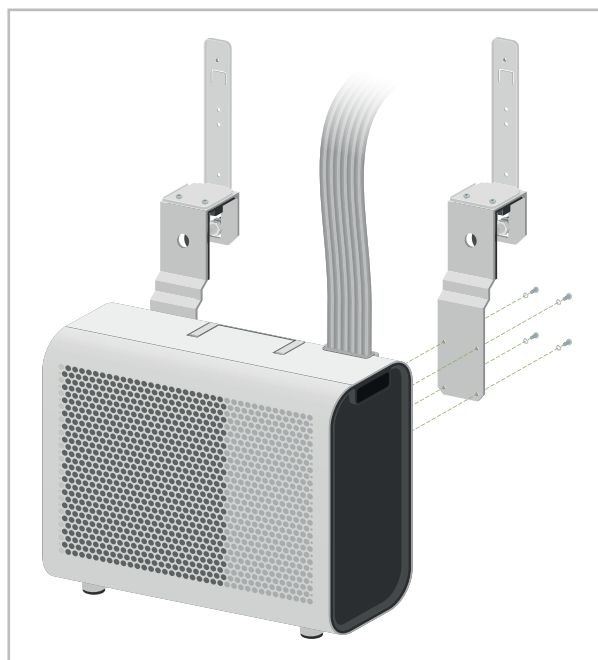
Abb. 8: Montage der Halterungen am Außenteil
