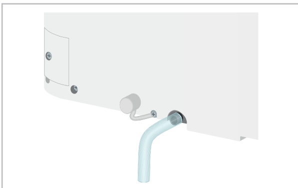
Abb. 13: Notentleerung am Innengerät
