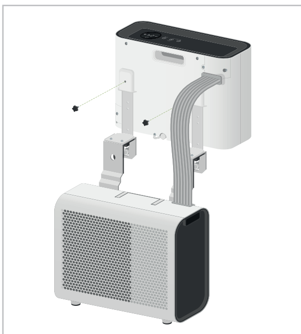
Abb. 10: Einschrauben der Sterngriffschrauben
