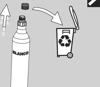
Dévisser le capuchon de protection de la bouteille de CO<sub>2</sub> et le recycler.
