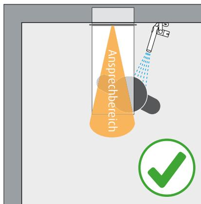
Wird die Handbrause so montiert, dass sich der Benutzer nicht im Ansprechbereich befindet, kann die Abschalt-Automatik-Funktion nicht aktiviert werden.
